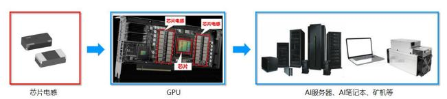
基于公司在金属软磁材料产品的持续迭代和性能领先,公司针对芯片电感开发出适用开关频率可达 5khz~10MHz 的金属软磁复合材料,为金属软磁材料进入更高频率段的半导体应用领域提供了可能性。在此基础上,公司经过多年的潜心研发,结合独创的高压成型结合铜铁共烧工艺,制造出了具有更高效率、小体积、高可靠性和大功率的芯片电感产品,从而为芯片供电模块向小型化、高功率化方向的快速发展提供必要条件,也为公司开启了一条更加广阔的服务半导体供电领域的新赛道,并最终完成了公司从发电端到负载端电能变换(包括 DC/AC,AC/AC,AC/DC,DC/DC)全覆盖的产品线布局,现已发展为公司的第二条增长曲线,对公司发展具有里程碑的意义。
