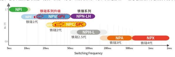
公司始终以终端应用需求为产品开发导向,以精密制造工艺为支撑,从"铁硅1代"金属磁粉芯开始,不断迭代升级至"铁硅4代",建立了一套覆盖  $5kHz^2MHz$  频率段应用的金属磁粉芯体系,可满足众多应用领域的性能需求,牢牢
