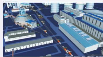
迁钢公司通过建立鱼雷罐跟踪系统，利用物流跟踪定位技术完成铁水运输过程数据实时采集，实现机车、鱼雷罐可视化跟踪，鱼雷罐全生命周期得到数字化、可视化管控。系统上线以后，铁水温降 11 月份 89.8℃，刷新历史纪录，鱼雷罐周转率 6.3 次 / 日，兑现铁水温控目标，达到行业领先水平。
