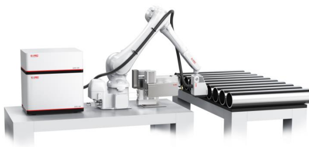
图 12 钢材智能在线实时分析系统（在线 LIBS 系统）
