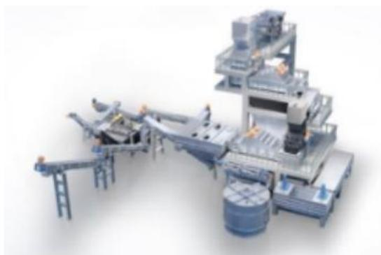
废铅酸蓄电池破碎分选设备是废铅酸蓄电池再生利用产业的核心设备，由破碎系统、分选系统、酸液循环系统三部分组成，主要作用是通过物理破碎和密度分选等工艺，提取废铅酸蓄电池破碎中的铅、铜、塑料等可再生物料，破碎能力和分选精度是衡量设备技术含量的重要指标。
