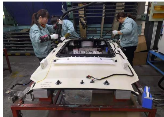
顶衬总成装配 过程
