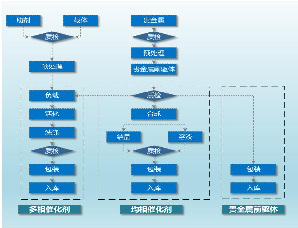
2、贵金属循环回收生产工艺流程图
