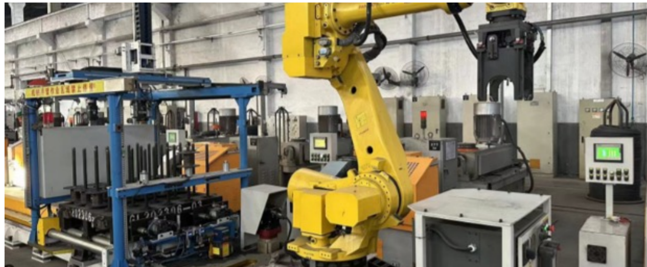
拉丝工序使用机械臂
