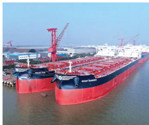
» LNG 双燃料动力纽卡斯尔型散货船 LNG dual-fuel powered Newcastlemax bulk carriers
