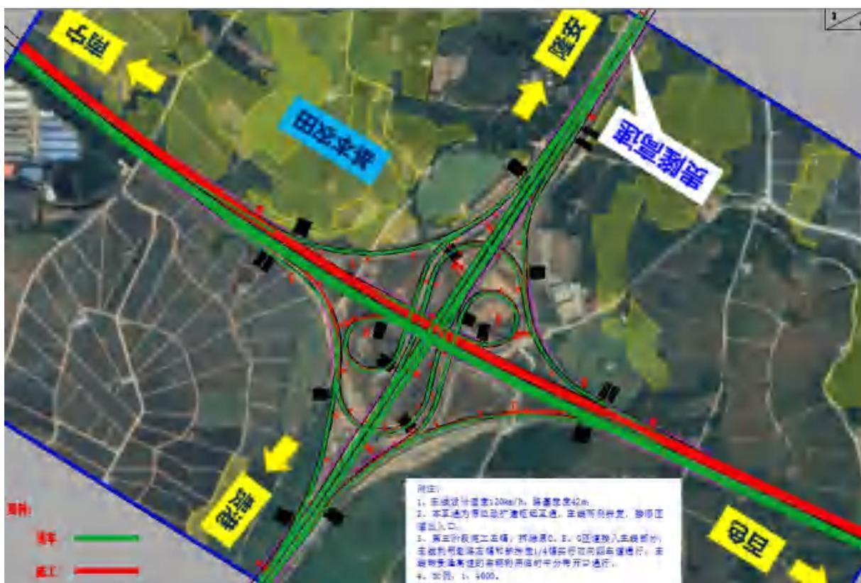
步骤四：施工附属工程量；拆除临时设施；主线双向八车道开放交通，来往贵隆高速车辆利用新匝道通行。
