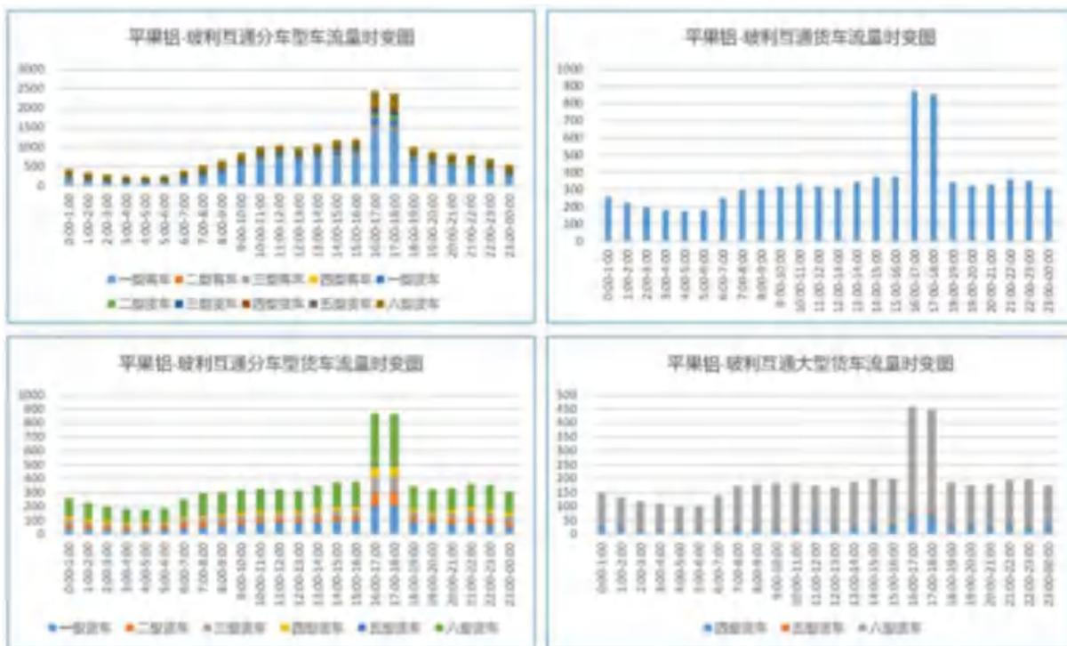
图 3.1.18 平果铝-玻利互通段车流量时变图
