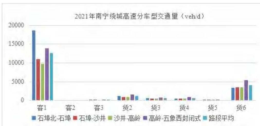
图 3.1.56 2021 年南宁绕城高速石埠至五象段路段平均交通量
