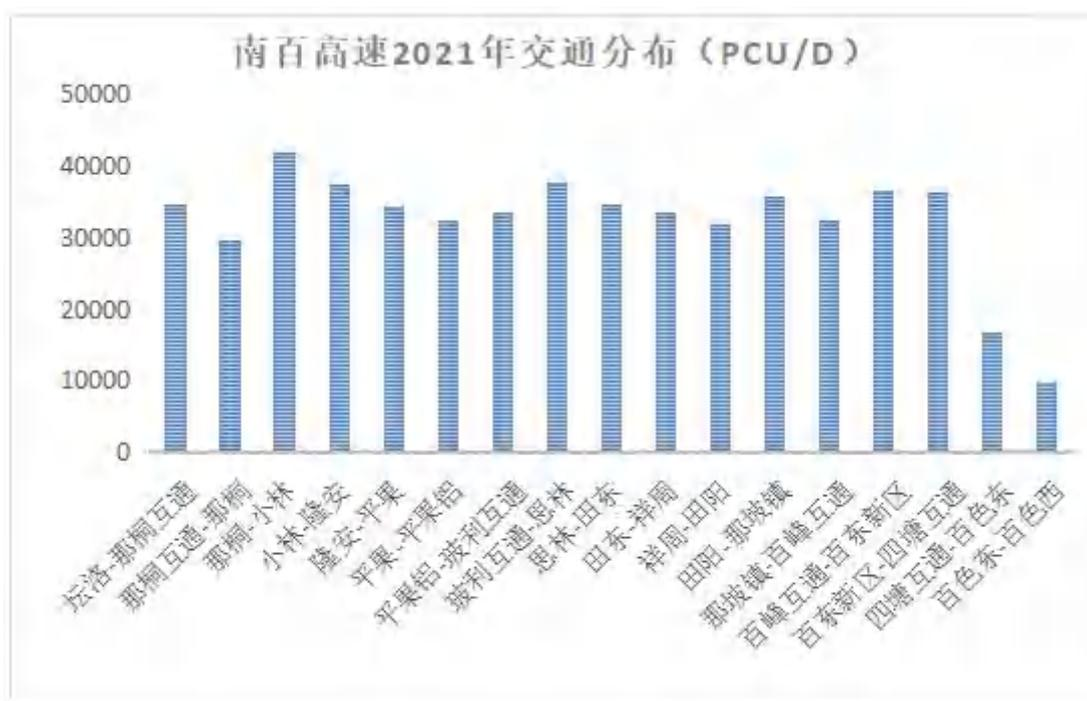
图 3.1.3 百坛高速公路断面车流量示意图
