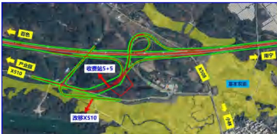
**方案二：**①充分利用既有互通用地进行改建，利用现有主线桥和环形匝道用地，原位改建；②匝道宽度按照标准化要求设计；③按设计速度 120km/h 规范要求选取加减速车道及渐变段长度；④环形匝道半径调整为  $R=60m$ ；⑤匝道收费站移位新建，同时需避让中石化加油站的场坪用地；⑥改移 X510 与 X508 平交，与互通连接线与 X508 的间距
