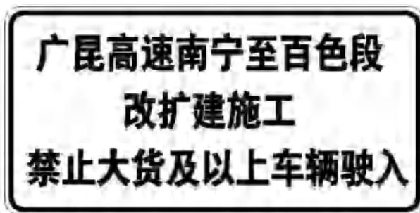
②禁令标志，配合告示标志使用，用于对过往车辆分车型分流。以分流大型货车及以上车型为例，如下：
