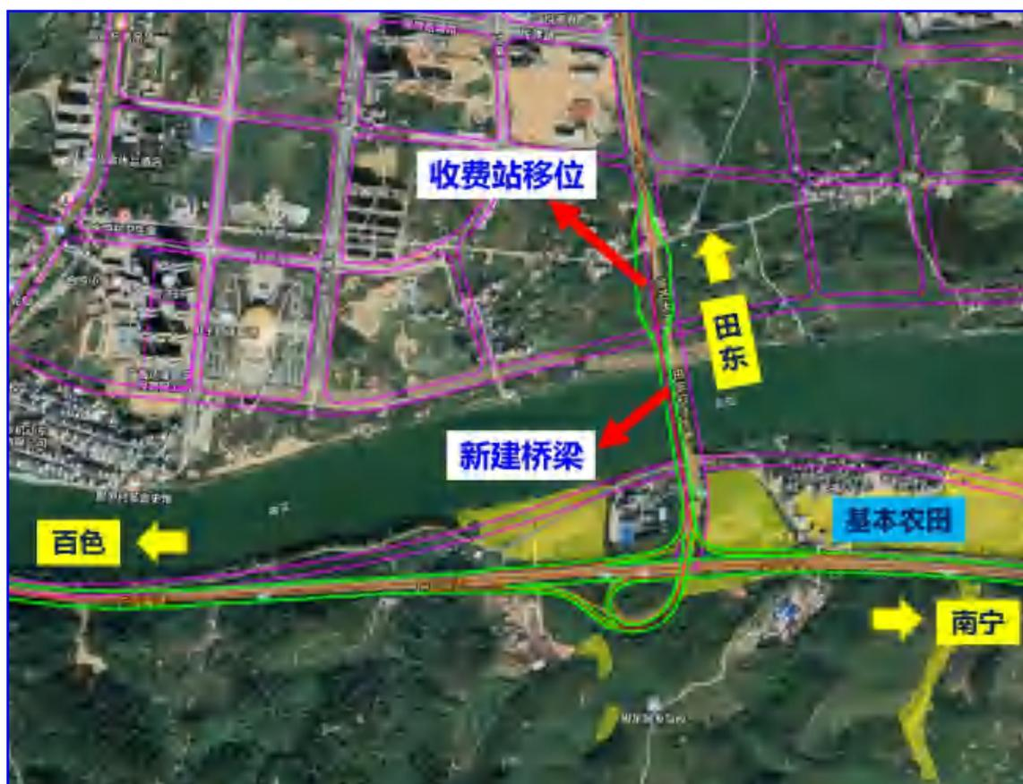
**方案二：**①利用既有田东右江大桥上下高速；②结合县城规划在恩隆大道处新建一座桥梁供地方进出县城使用；③匝道宽度按照标准化要求设计；④按设计速度 120km/h
