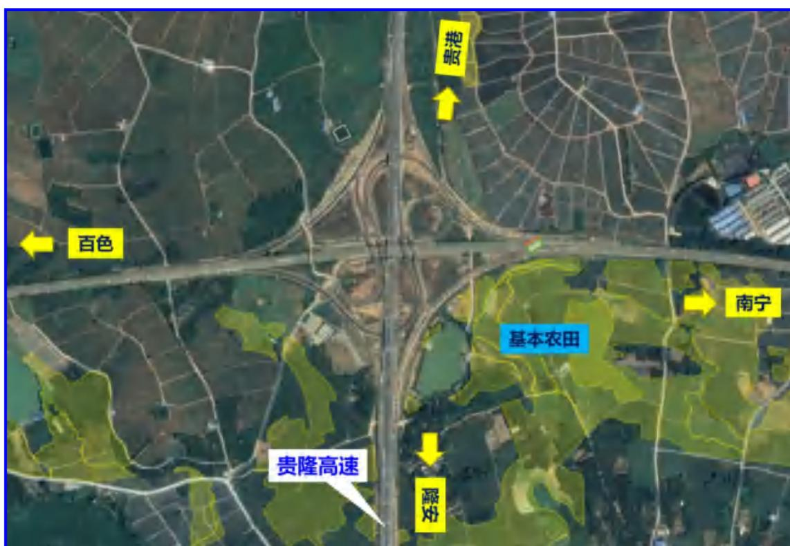
步骤一：新建主线两侧拼宽部分，互通范围内主线两侧加减速车道提前施工；新建A、C、E、F、G、H匝道与主线合流部分；老路正常通行。
