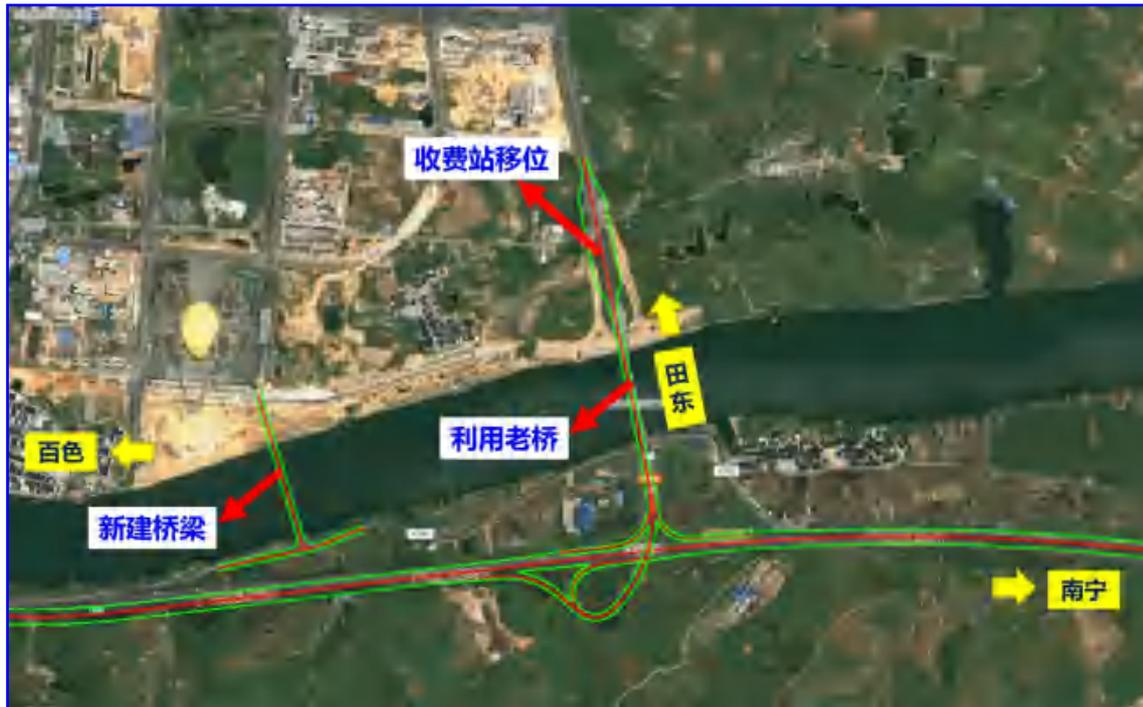
方案三：①将互通改为 T 型，布设在临近右江一侧；②将收费站向高速一侧移位新建并进行扩容设计；③匝道宽度按照标准化要求设计；④按设计速度  $120\text{km/h}$  规范要求选取加减速车道及渐变段长度；⑤调整互通各项指标均满足设计速度  $120\text{km/h}$  规范要求；⑥结合县城规划在恩隆大道处新建一座桥梁供地方进出县城使用。
