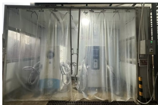
图注:公司开展淋水测试循环,实现 100% 循环再利用
