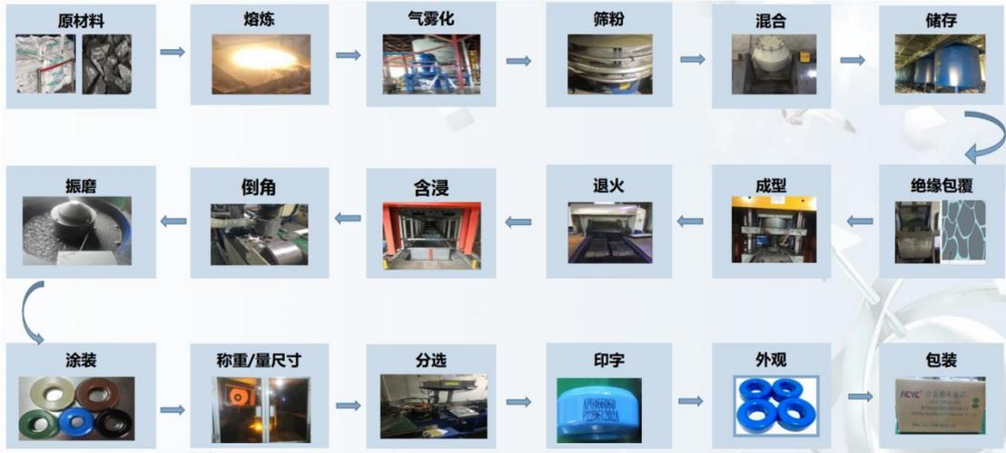
安可远主要采用以销定产，同时预测客户需求及市场供应情况予以备货的生产模式。安可远生产工序较多，先后有熔炼制粉、粉末筛分、绝缘包覆、成型、退火、含浸、振磨、表面涂覆、分选、粘接、包装等工序。
